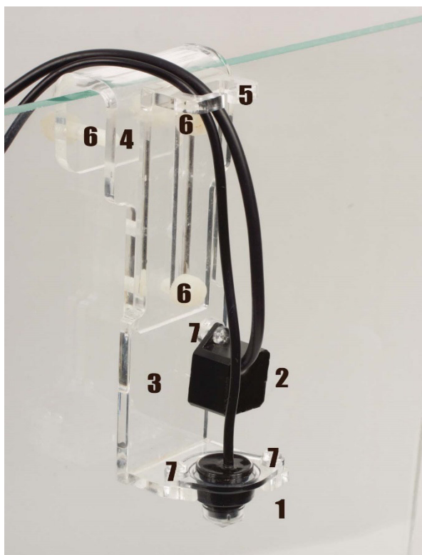
Photo 6: Montage des sondes N1 et N2 avec les supports fournis.
